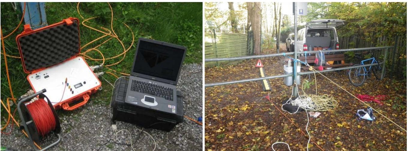
Abb. 4: Links: Steuereinheit der Multielektrodenanlage. Rechts: Kabelauslage auf der Hangschulter (Transekt 1 – Burgweg).
