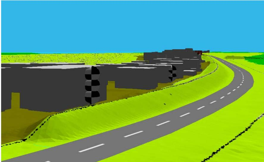
Abbildung 5. Schallschutzwall entlang der B 11 (Ausschnitt), EDV-Grafik.
