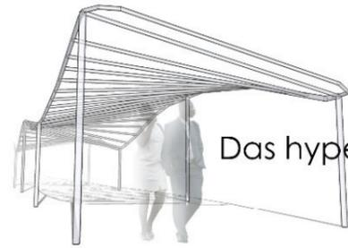
Das hyperbolische Paraboloid - Konstruktionskonzept
