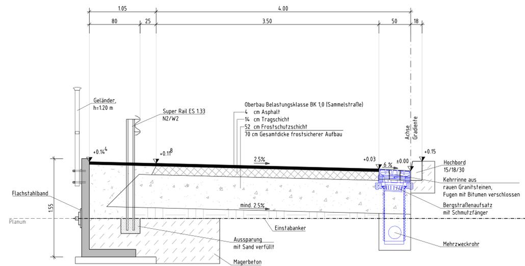
Regelquerschnitt - Variante Kastenrinne M 1:20
