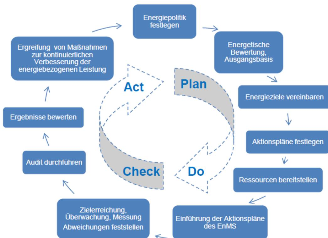
**Abbildung 2.2** Veranschaulichung eines PDCA-Zyklus im Rahmen eines Energiemanagement-Regelkreissystems nach [2].
