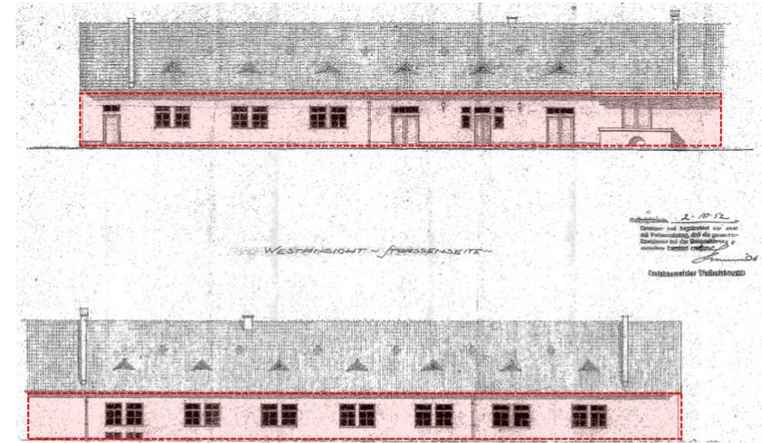
Abb. 36: Kennzeichnung zu dämmende Flächen
