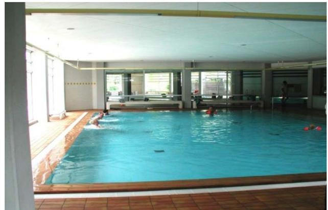
Wassertiefe 0,60 m – 1,25 m. An der Zugangsseite ist eine durchgehende Treppe eingebaut. An der gegenüberliegenden Langseite sind Unterwasser-Massagedüsen angeordnet. Die Beckenumgangsfläche beträgt 127 m<sup>2</sup>. Die freien Durchgangsbreiten der Umgänge messen 1,49 m bis 2,50 m, das sind Mindestmaße.
