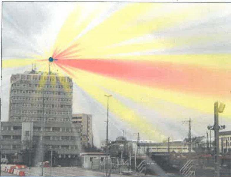
2D-Simulation des Feldes einer Mobilfunkantenne.
